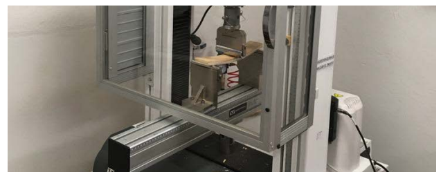
Probando el módulo de elasticidad (MOE)
